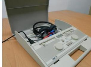
**說明：**測量人在接收到不同程度分貝音量刺激下，感覺能夠察覺的程度。
