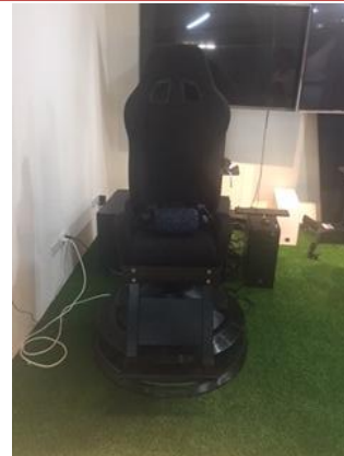
說明：虛擬實境 VR 動感模擬設備座椅模組
