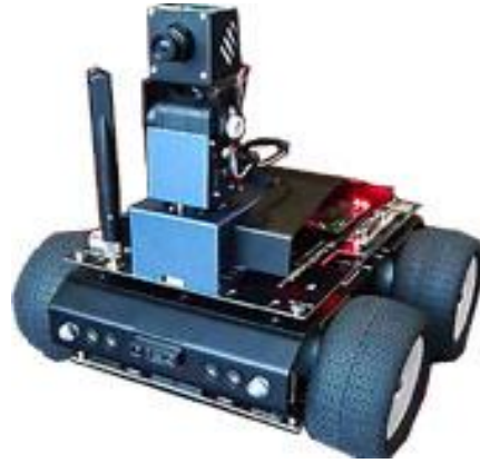
說明：具影像功能輪型機器人
