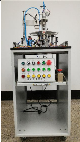
說明：材質分揀與加工實驗平台
