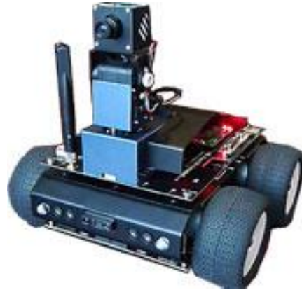
說明：具影像功能輪型機器人
